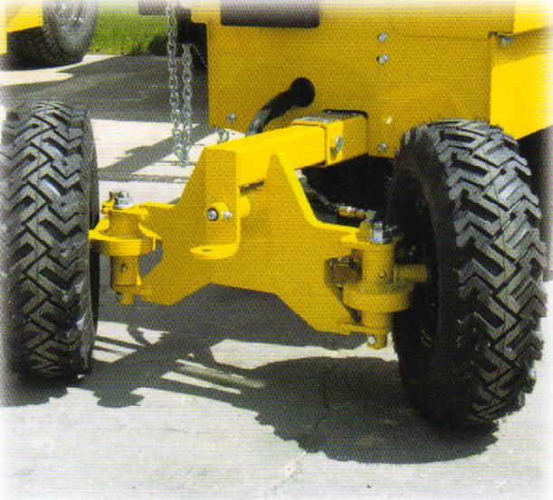
Die SC252 mit abnehmbarer Vorderdeichselbaugruppe ermöglicht verschiedene Vorderradoptionen. Innovative Konstruktionsmerkmale und die kleine Breite der SC252 sorgen für einen bequemen Transport der Anlage.
